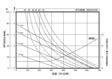
性能基于弹性装配泵 (PW20P-YPS-XXX)、灌注抽吸环境条件下的水。由于结构材料、装配配置和工作条件不同,公布的数据仅供参考。
